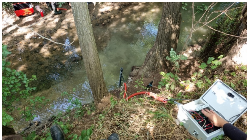
Figure 1 : déploiement d'une sonde de niveau d'eau et d'un nœud satellitaire sur le ruisseau de l'Angaud à Billom (63) en juillet 2025
